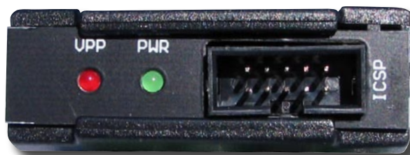
Fot. 4. Rozmieszczenie i funkcje diod LED oraz umiejscowienie złącza ICSP
