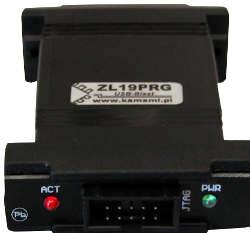
Fot. 4. Umieszczenie diod sygnalizujących stan pracy programatora ZL19PRG
