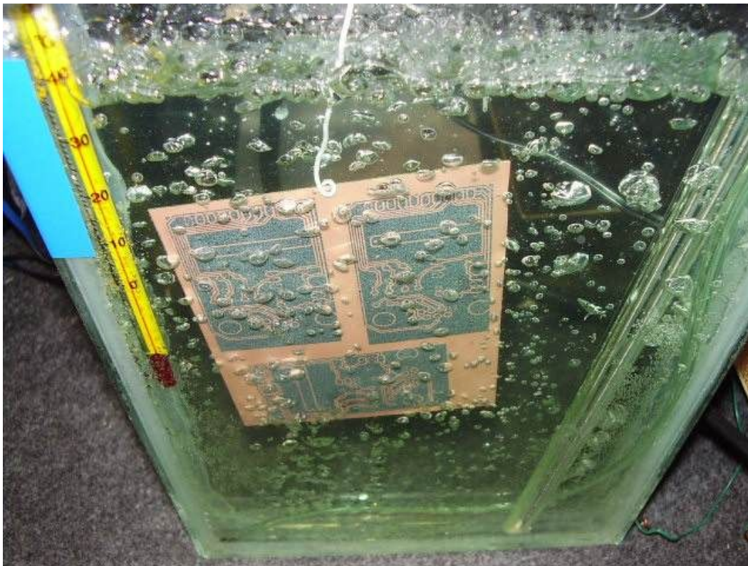
Rys. Trawienie płytki w bąbelkach :)
