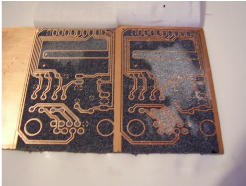
Rys. Ściągnięty papier, toner i kreda na płytce. Jak widać papier odchodzi ale zostaje kreda na tonerze. Resztki papieru trzeba usunąć i ścierają się bardzo łatwo palcem. Większość zaleca dokładne pozbycie się kredy przez pocieranie palcem lub przy użyciu małej ilości CIF'u. Ja proponuje kilka razy potrzeć palcem całą płytkę tak by nie była aż taka biała ale też nie ścierać całkiem aż do czarnego tonera.
